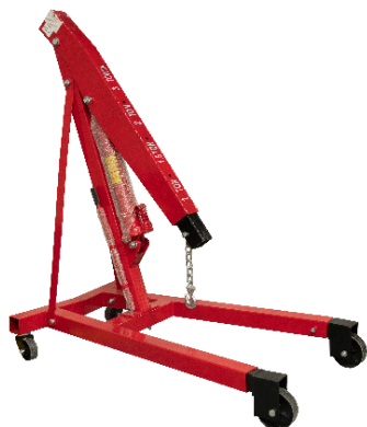
TECLE PLUMA CAPACIDAD: 3 TON. SISTEMA HIDRÁULICO PESO: 28KG. PROCEDENCIA: BRASIL DIMENSIONES: 35X82X12 CAPACIDAD DE LA GATA : 3 TONELADAS
