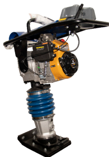
VIBROAPISIONADOR TIPO ROBIN 4HP POTENCIA: 4HP PESO: 75KG ENCENDIDO MANUAL REVOLUCIONES: 640-700 RPM PROCEDENCIA: JAPAN
