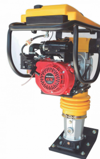
VIBROAPISIONADOR HONDA GX 160 POTENCIA: 4HP PESO: 75KG ENCENDIDO MANUAL REVOLUCIONES: 640-700 RPM PROCEDENCIA: JAPAN
